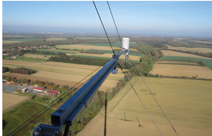
2. fénykép. Meteorológiai érzékelők és levegőbeszívó csövek 115 m magasan.
